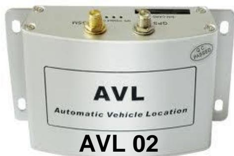
El **AVL02** en la actualidad es el más avanzado dispositivo rastreador GPS/GSM/GPRS diseñado especialmente para brindar rastreo, monitoreo en tiempo real, seguridad para Motos, control de velocidad y ruta recorrida, el AVL02 brinda estabilidad y mayor precisión incluso en lugares remotos. Rastreo GPS, Bloqueo GSM, horas encendido y parqueo; kilometraje recorrido y combustible consumido.
